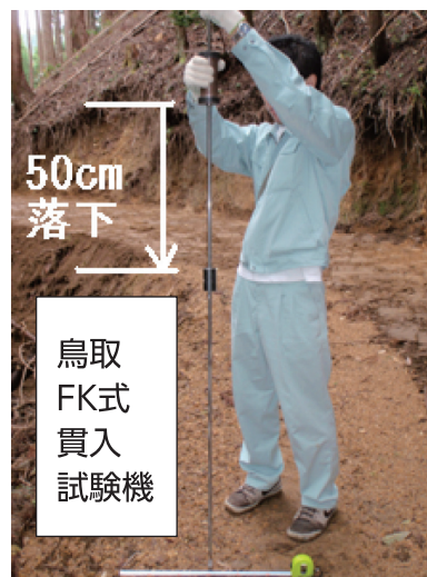
おもりを5回落下させて貫入量を測定
